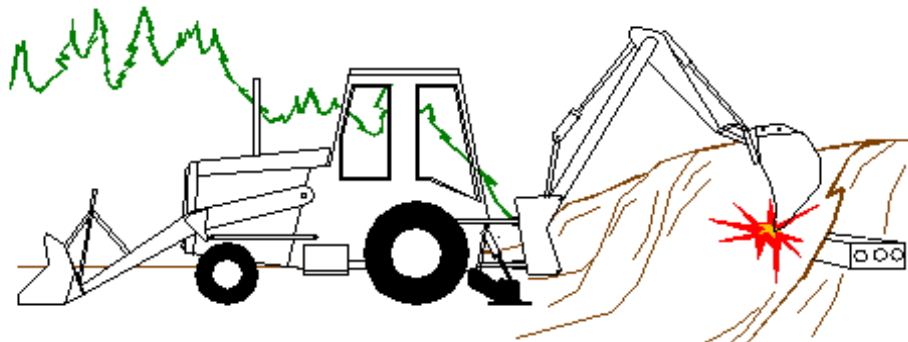
Figura 1 – Contatto con linee elettriche interrate
